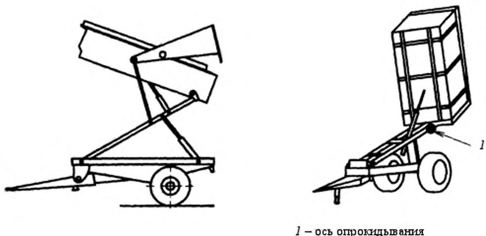
Рисунок 3 – Примеры полуприцепа с высоким опрокидыванием
