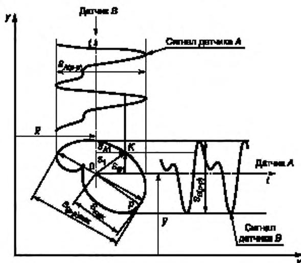
$x, y$  — неподвижная система координат;  $O$  — среднее по времени положение траектории орбиты;  $x, y$  — средние значения перемещений вала;  $K$  — мгновенное положение центра вала;  $P$  — положение вала при его максимальном отклонении от среднего положения;  $S_1$  — мгновенное значение перемещения вала;  $S_{\max}$  — максимальное отклонение вала от среднего положения;  $S_{A1}, S_{B1}$  — мгновенные значения перемещений в направлениях измерений датчиков А и В соответственно;
