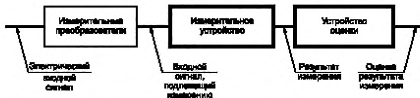
Рисунок 1 — Полная измерительная цепь
