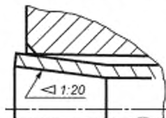
Рисунок 10 — Коническая развальцовка перед сваркой
