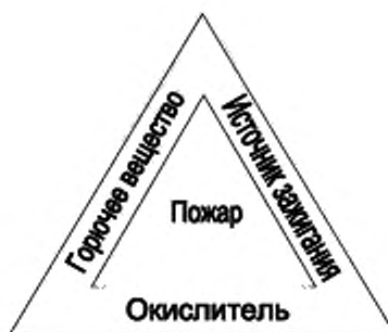
Рисунок 2 – Возникновение пожарной опасности
