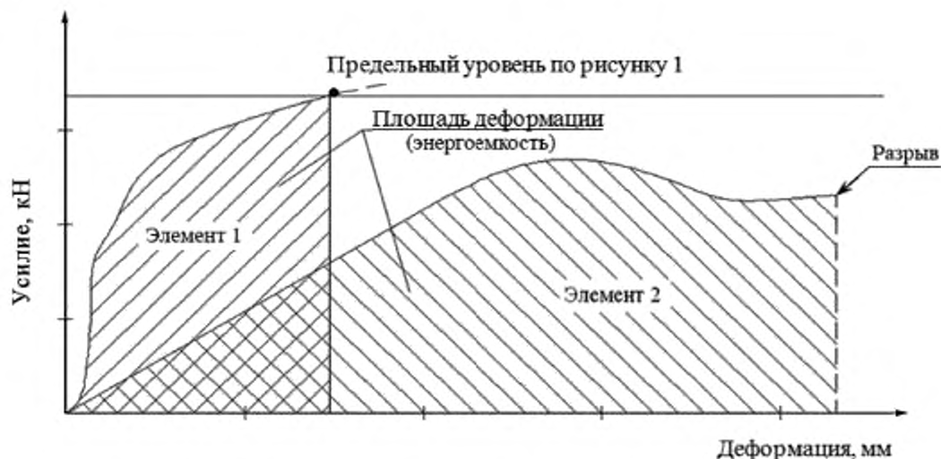
Рисунок 2 — Примеры диаграмм деформации элементов (фрагментов) барьерного ограждения при различных случаях завершения испытаний по 5.3.1
