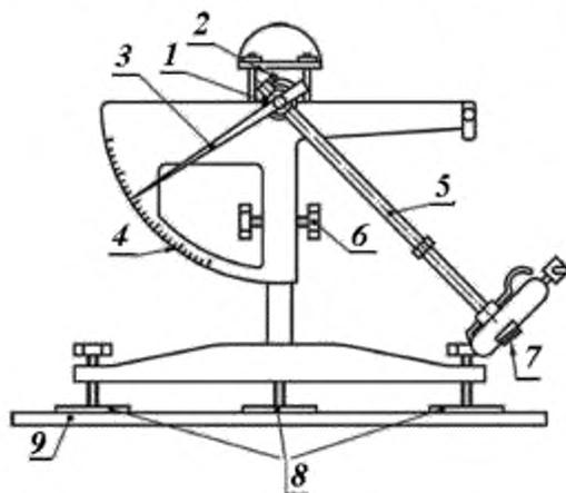
1 — муфта; 2 — регулировочный винт; 3 — контрольная стрелка; 4 — шкала; 5 — маятник; 6 — подъем/опускание маятникового механизма; 7 — салазки; 8 — регулируемые опоры; 9 — деревянная плита (толщина = 10 мм)
