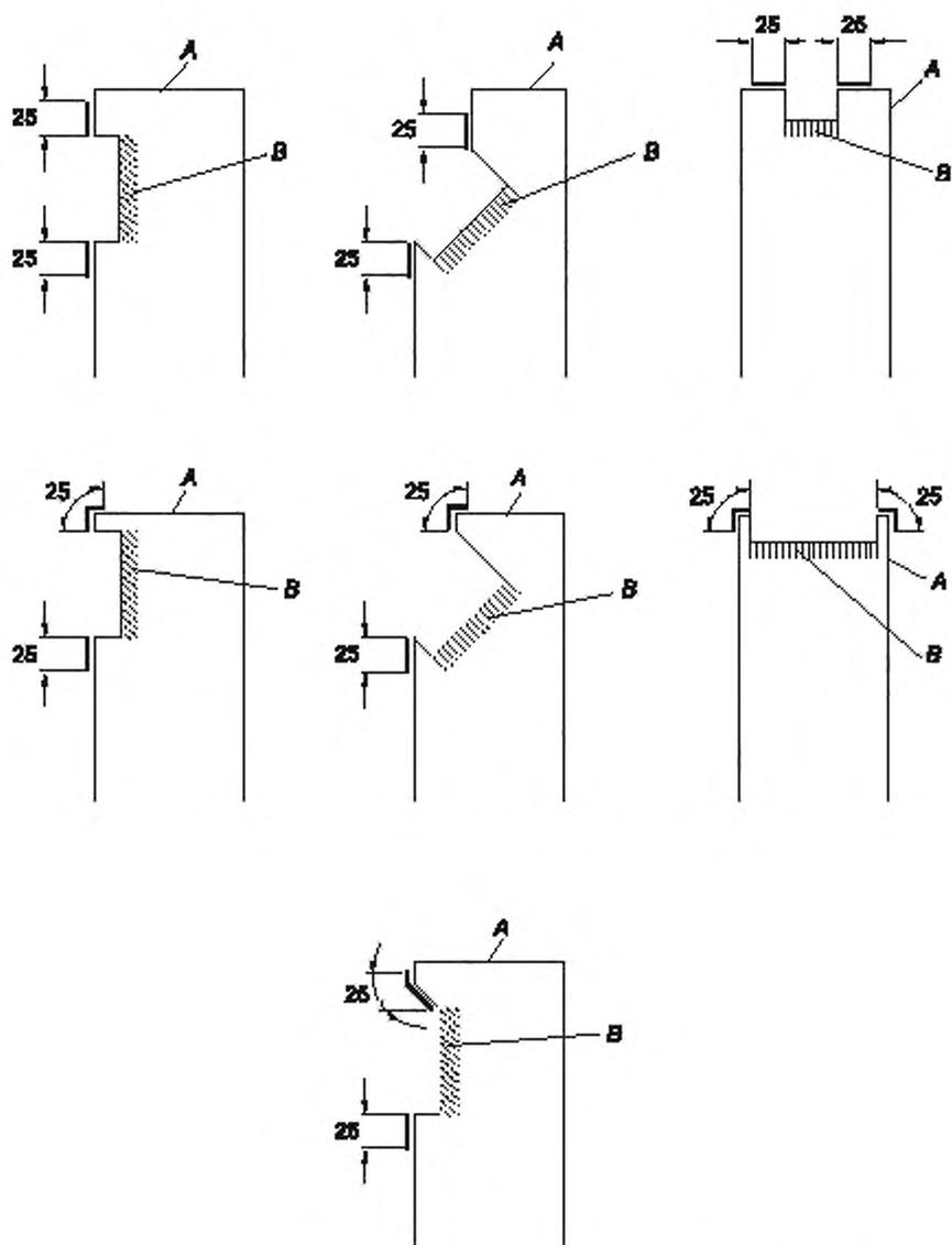
A — корпус обогревателя; B — защитная решетка отверстия для выхода воздуха
