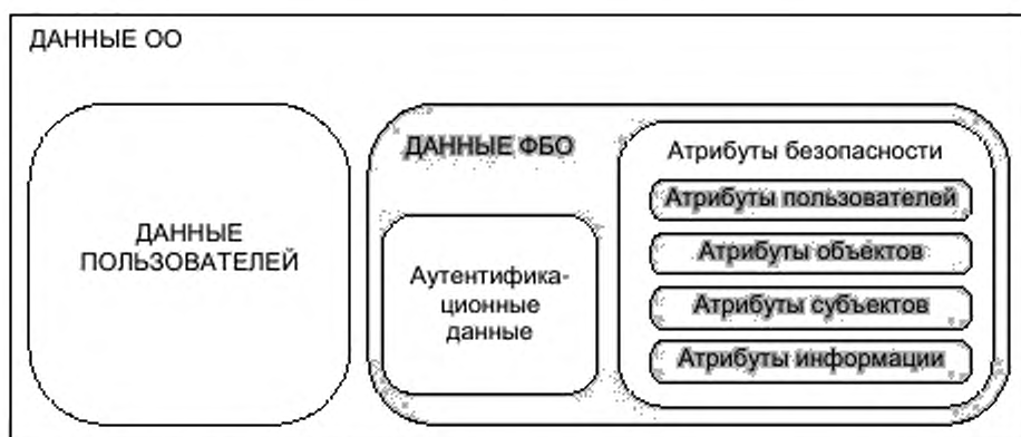
Рисунок 1 – Связь между данными пользователей и данными ФБО
