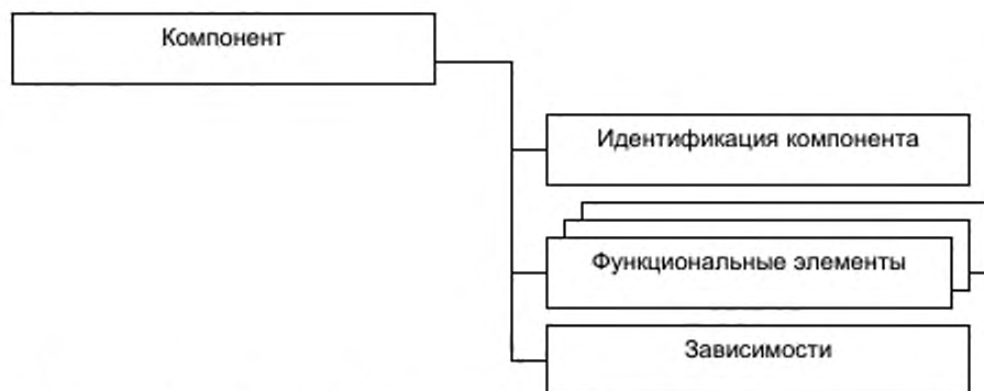
Рисунок 5 – Структура функционального компонента
