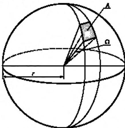
Рисунок 3 — Определение телесного угла
