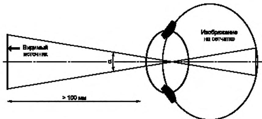
Рисунок 1 — Определение углового размера  $\alpha$  видимого источника
