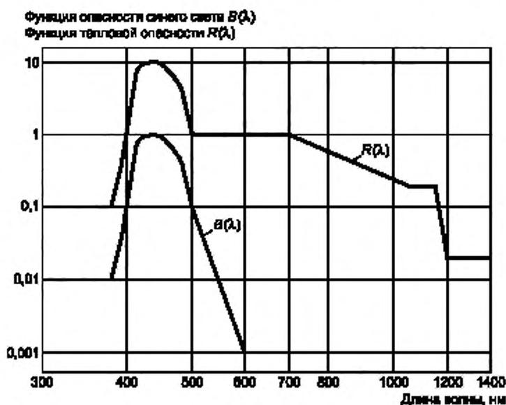
Рисунок 6 — Функция тепловой опасности для сетчатки  $R(\lambda)$  и функция опасности синего света для сетчатки  $B(\lambda)$
