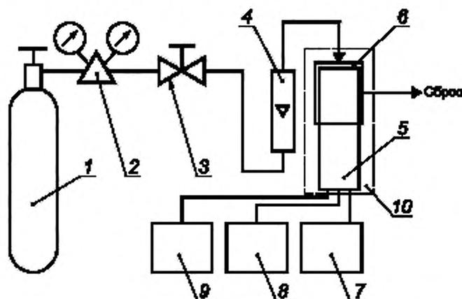
1 — источник ГС (баллон или динамический генератор); 2 — редуктор баллонный (только для подачи ГС из баллонов под давлением); 3 — вентиль точной регулировки (только для подачи ГС из баллонов под давлением); 4 — ротаметр; 5 — СИ; 6 — насадка для подачи газа; 7 — блок питания СИ; 8 — вольтметр цифровой универсальный; 9 — вторичное устройство для контроля цифрового выходного сигнала; 10 — камера климатическая (только при проведении операций поверки по 9.4.2 или 9.4.3)
