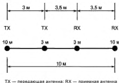
Рисунок 31 — Размещение испытательных точек для измерительного расстояния 3 м
