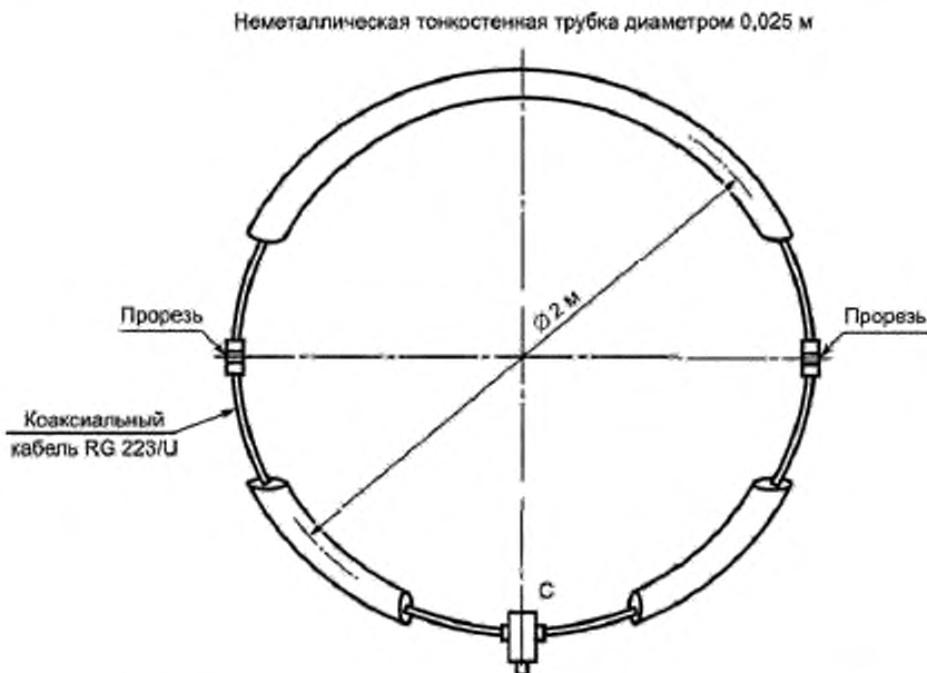
Рисунок С.2 — Большая рамочная антенна с двумя противоположными прорезями, расположенными симметрично относительно токосъемника С
