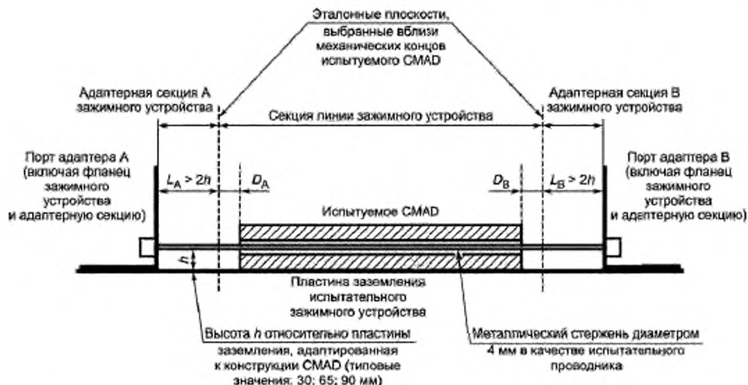
Рисунок 23 — Определение эталонных плоскостей внутри испытательного фиксирующего устройства
