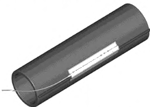
Рисунок F.2 — Датчик ограничителя температуры на оболочке электроннагревателя
