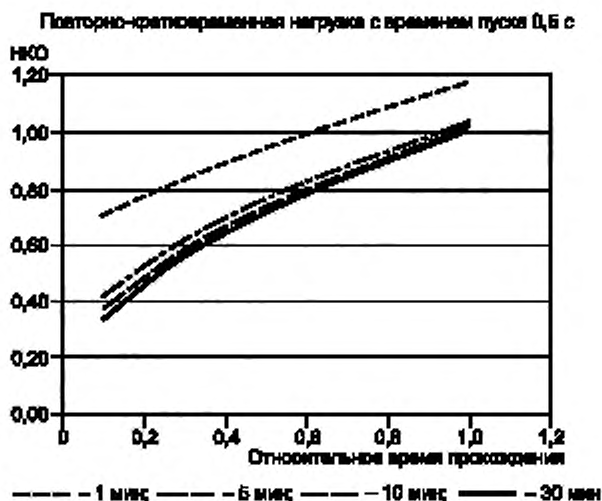
Рисунок E.7 — Графический пример соотношения между эквивалентным НКО и параметрами при повторно-кратковременном режиме t_1 = 0,5 с, t_1 = 7 \times I_2 для разного времени цикла
