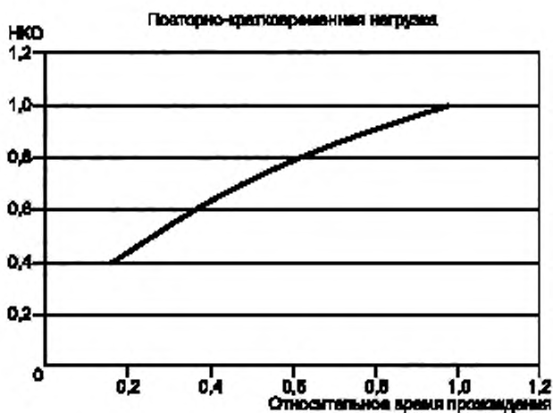
Рисунок E.8 — Графический пример соотношения между эквивалентным НКО и параметрами при повторно-кратковременном режиме I_1 = I_2 (без пускового сверхтока)
