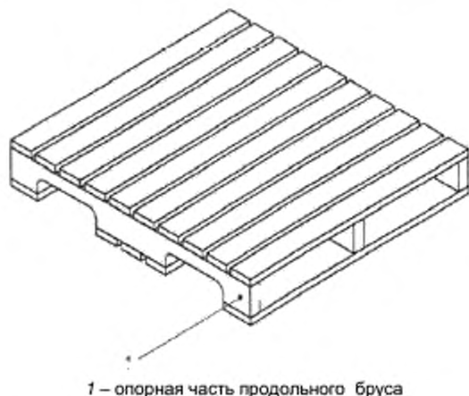
Рисунок 53 – Опорная часть продольного бруса
