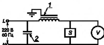
1 — пускорегулирующий аппарат; 2 — конденсатор для повышения коэффициента мощности
