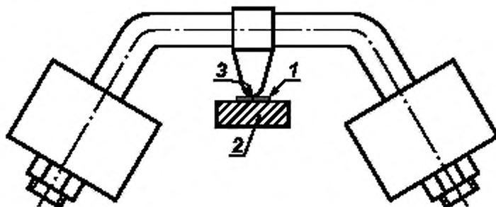
1 — образец; 2 — опора; 3 — сферический радиус  $R = 2,5$  мм
