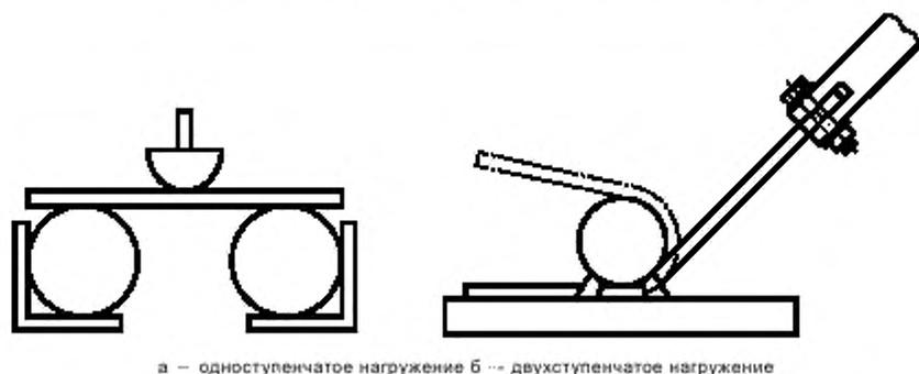
а — одноступенчатое нагружение б — двухступенчатое нагружение
