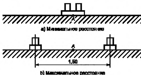
Рисунок В.1 — Установка акселерометров при определении f_2
