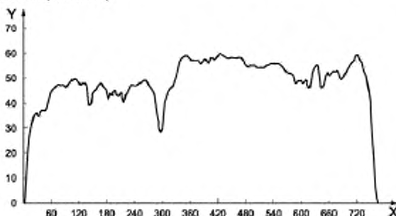
Рисунок С.2 — Последовательность испытаний транспортного средства, имитирующих загородное движение в условия США, в соответствии с загородным экономичным циклом движения (HFEDS)
