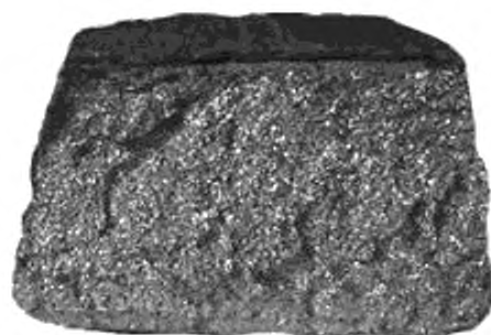
Рисунок Б.10 — Излом мелкозернистый, кристаллический
