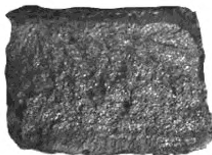
Рисунок Б.11 — Излом мелкозернистый, кристаллический
