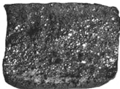
Рисунок Б.12 — Излом среднезернистый, кристаллический
