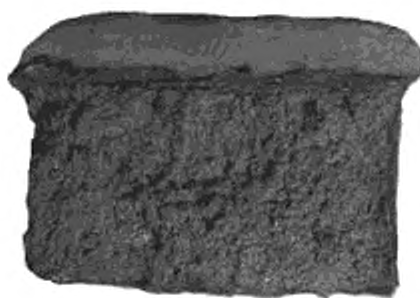
Рисунок Б.1 — Излом мелкозернистый, матовый
