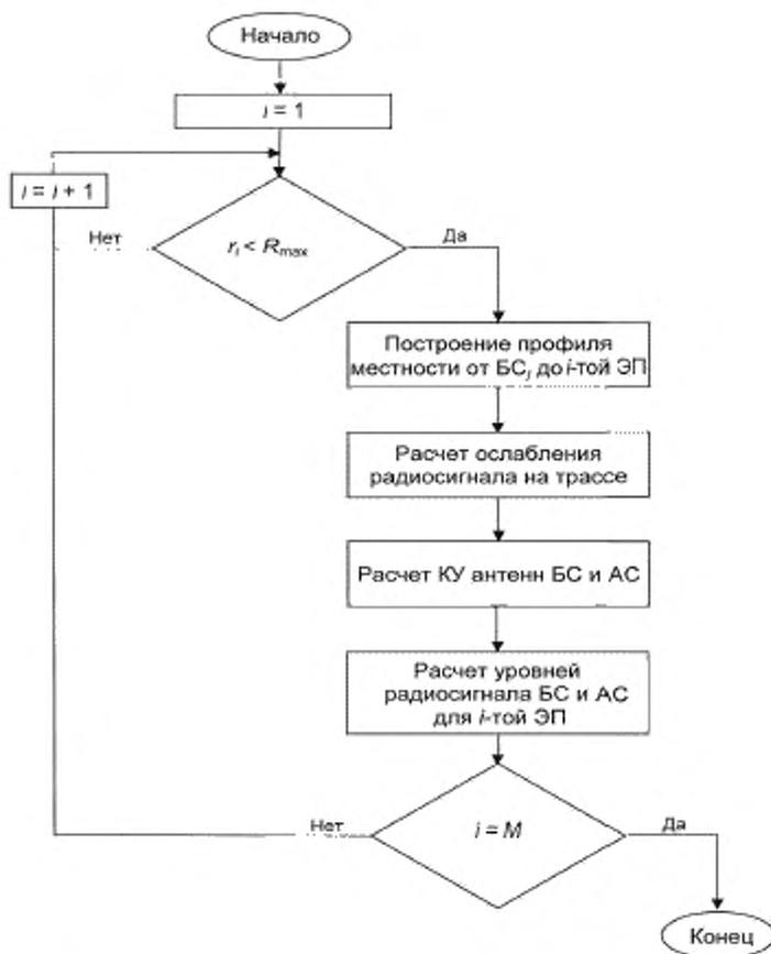
Рисунок 4.2 — Блок-схема алгоритма построения радиопокрытия БС
