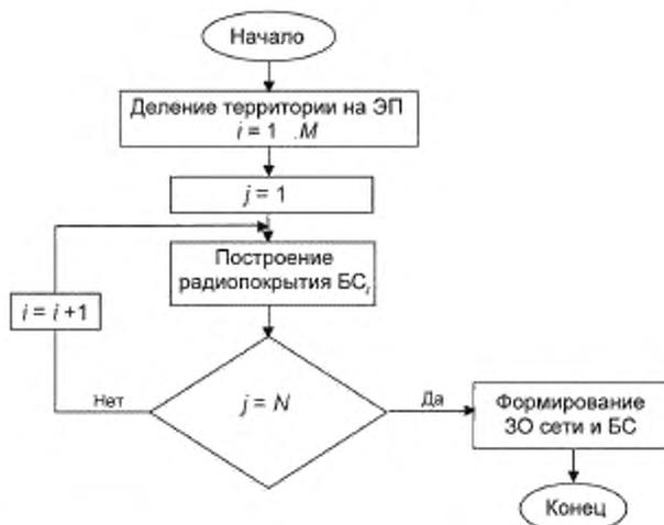
Рисунок 4.1 — Блок-схема алгоритма построения зон обслуживания
