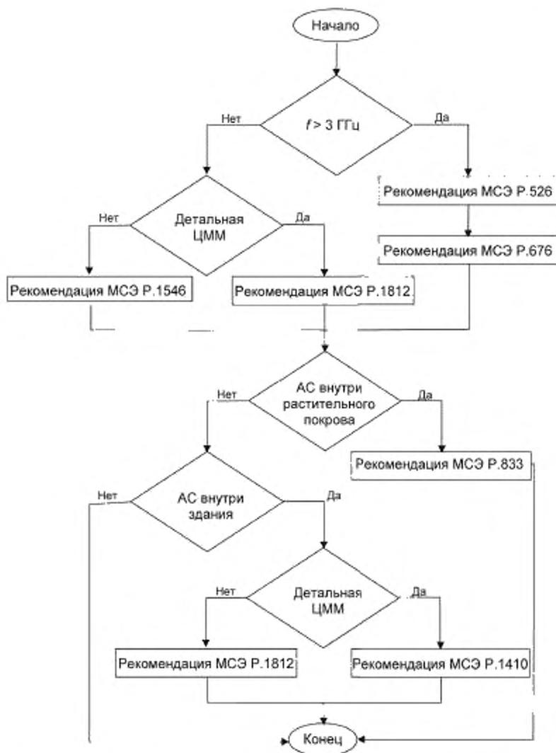
Рисунок 4.3 — Блок-схема алгоритма расчета ослабления радиосигнала на трассе
