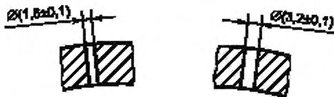
б — Сквозное отверстие
