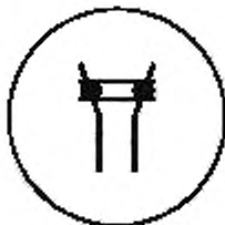
Рисунок L.2 — Символ маркировки аппарата, содержащего механически связанные контакты
