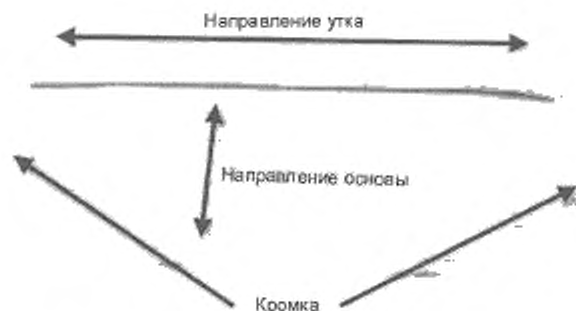
Рисунок 6 — Образец усадки шерсти, неразрезанный
