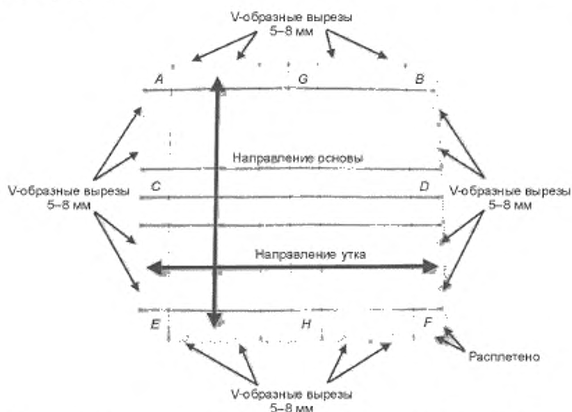
Рисунок 7 — Образец усадки шерсти, расплетенные кромки и V-образные вырезы
