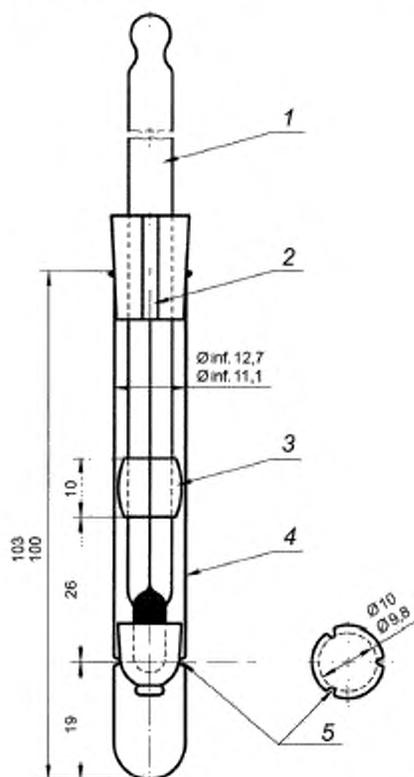
1 — термометр; 2 — прорезь в пробке для выпускного отверстия; 3 — корковая пробка, обеспечивающая при установке зазор с внутренней стенкой пробирки 1,5 мм; 4 — пробирка для испытания из боросиликатного стекла, 5 — три углубления, расположенные на одинаковом расстоянии друг от друга, для удерживания тавотницы
