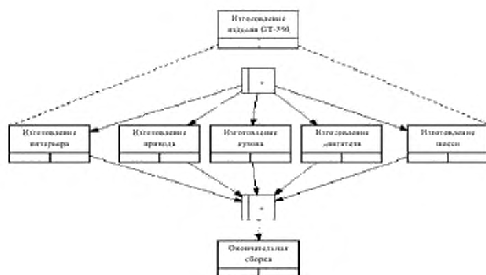
Рисунок В.1 – Блок-схема производственного процесса высокого уровня, применяемого для изготовления изделия GT-350 [8]
