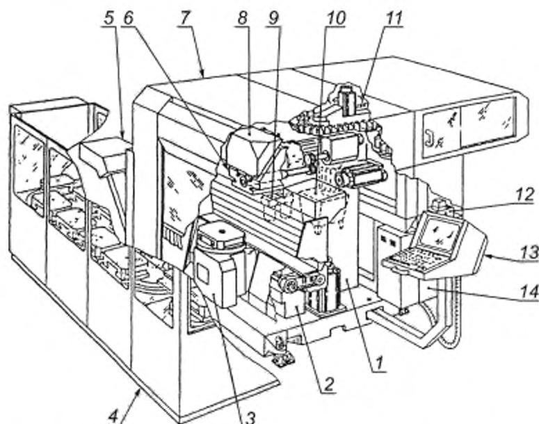
1 — стойка с приводом подачи, ось Y; 2 — поперечный ползун с приводом подачи, ось X; 3 — рабочий стол; 4 — склад паллет, 5 — конвейер для стружки; 6 — шпиндельная бабка с главным приводом и приводом подачи, ось Z; 7 — ограждение; 8 — устройство смены инструмента; 9 — пневматический блок; 10 — гидравлический блок; 11 — инструментальный магазин; 12 — смазочная станция, 13 — пульт управления, 14 — электрошкаф
