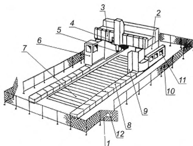
1 — ворота ограждения; 2 — передвижной портал, 3 — телескопические стальные оболочки; 4 — дополнительный пульт (только для режима 2); 5 — фреза; 6 — кабина, закрытая с трех сторон, перемещается с порталом; 7 — стол станка, 8 — крышки над ползунами; 9 — заслонка для стружки; 10 — ограждение по периметру; 11 — автоматическое устройство для смены инструмента; 12 — предупреждающие знаки
