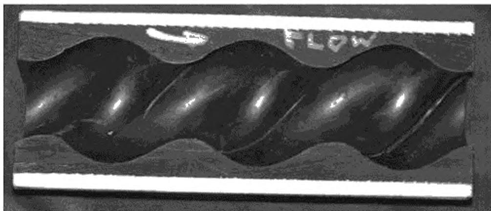
Рисунок 1.7 — Эродированный/ вымытый в результате интенсивной эксплуатации
