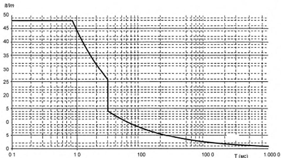
Рисунок 2 — Максимальные характеристики пускового тока для телекоммуникационного и информационного оборудования при номинальном напряжении и максимальной нагрузке
