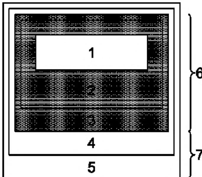
1 — данные прикладной программы схемы безопасности; 2 — процедуры безопасности, например, идентификация; 3 — кодирование достоверности, например, CRC; 4 — протокол передачи; 5 — код передачи (блок данных для срочной передачи); 6 — уровни безопасности; 7 — передающие уровни
