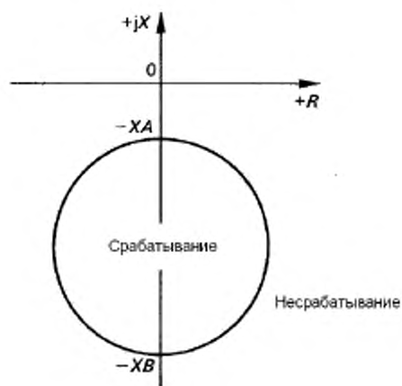
Рисунок 1е — Круговая характеристика межфазного повреждения прямого направления (влево) и обратного направления (вправо)
