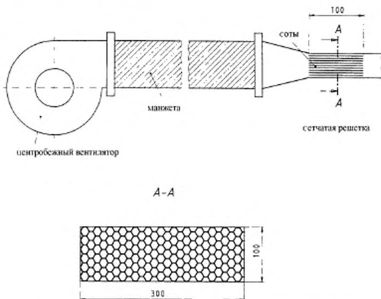
Рисунок 4 — Устройство для испытания на ветроустойчивость
