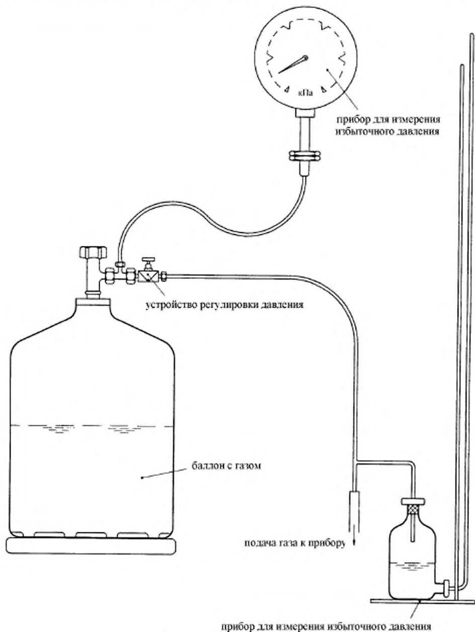
Рисунок 3 — Аппаратура для измерения повышения давления газа
