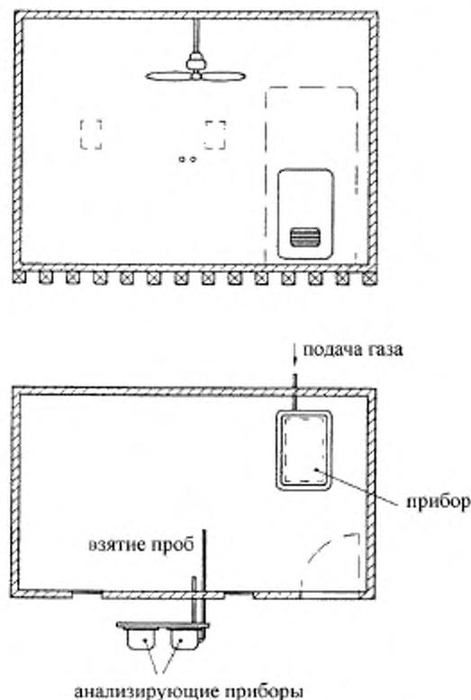
Рисунок В.1 — Помещение для испытания с воздухом, содержащим CO<sub>2</sub>
