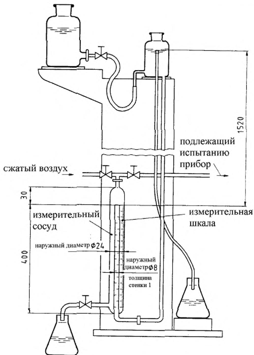
Рисунок 2 — Устройство для испытания прибора на герметичность
