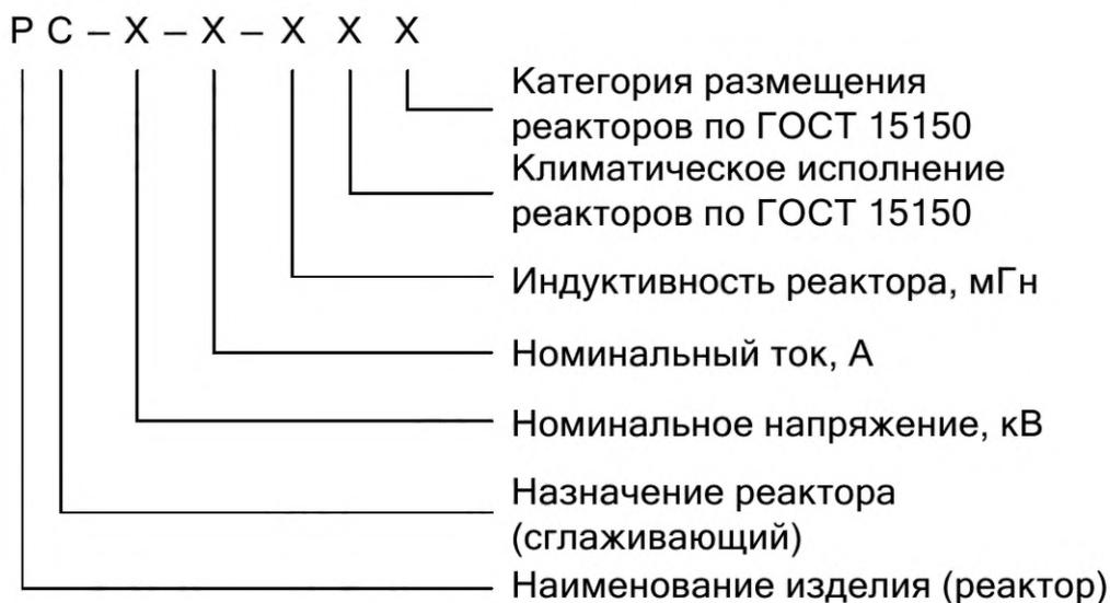
**Пример** условного обозначения сглаживающего реактора номинальным напряжением 3,3 кВ, номинальным током 4000 А, индуктивностью 4,5 мГн, климатического исполнения У, категории 1:
