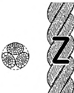
Рисунок 1- Конфигурация 3-прядного крученого каната (тип А)
