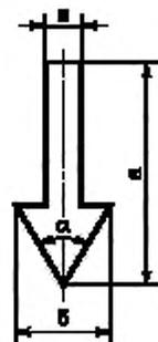
$a = 180\text{--}200\text{ мм}$ ;  $b = 80\text{--}100\text{ мм}$ ;  $\alpha = 30\text{--}40^\circ$ ;  $\alpha = 60^\circ\text{--}70^\circ$
