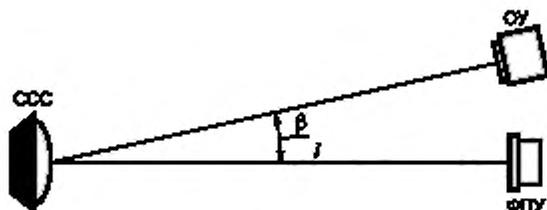
ОУ — осветительное устройство; ФПУ — фотоприемное устройство;  $\beta$  — угол падения луча ОУ на CCC (угол засветки CCC);
