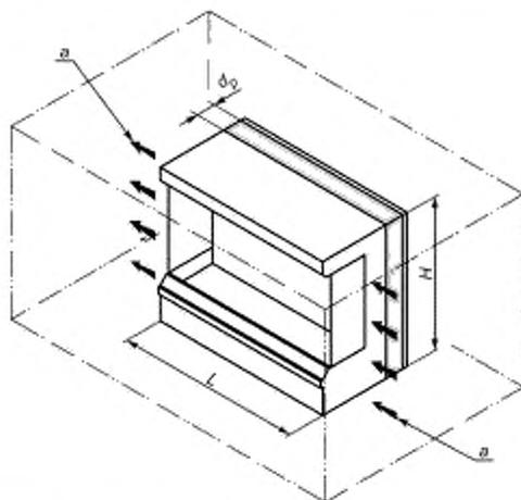
$d_p$  — расстояние от задней стенки образца до панели, предписанное изготовителем;  $H$  — высота воздушного канала (равна высоте шкафа);  $L$  — длина воздушного канала (равна длине шкафа);  $a$  — направление воздушного потока в помещении для проведения испытаний (параллельно плоскости открытой части образца в продольном направлении)
