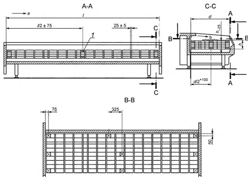
1 — термометрический контрольный пакет;  $l$  — длина витрины;  $d$  — глубина основания полезного объема;  $h$  — предельная высота загрузки;  $a$  — движение воздуха в помещении для проведения испытаний параллельно плоскости открытой поверхности витрины (в продольном направлении);  $b$  — направление принудительного обдува в полезном объеме витрины
