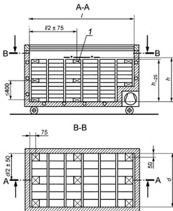
$l$  — длина витрины;  $d$  — глубина основания полезного объема;  $h$  — предельная высота загрузки;
