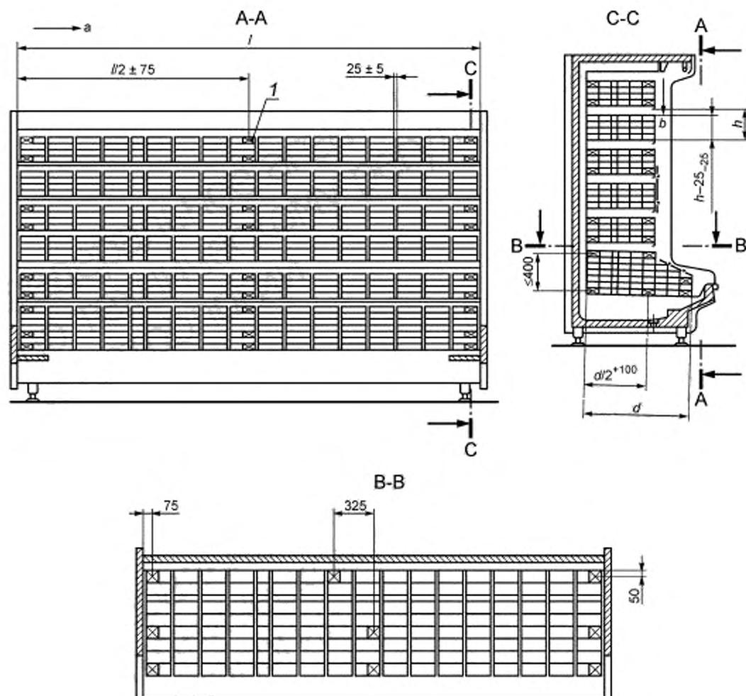
$l$  — длина шкафа;  $1$  — термометрический контрольный пакет;  $d$  — глубина основания полезного объема;
