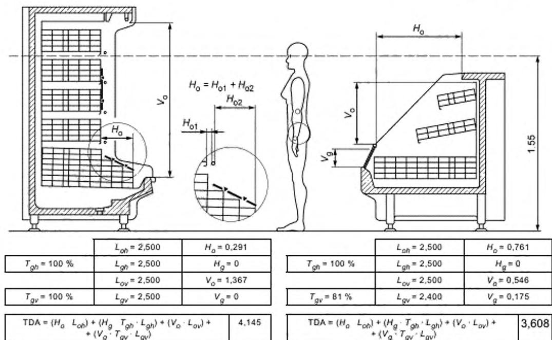
Рисунок А.3 — Вертикальный многоярусный шкаф и горка
