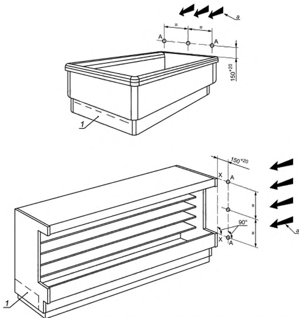
A-A — линия измерения скорости воздушного потока; X-X — опорная линия, соединяющая конец верхней части и конец нижней части корпуса образца; 1 — возможное расположение встроенного компрессорно-конденсаторного агрегата, а — движение воздушного потока параллельно к плоскости открытой части образца (в продольном направлении)
