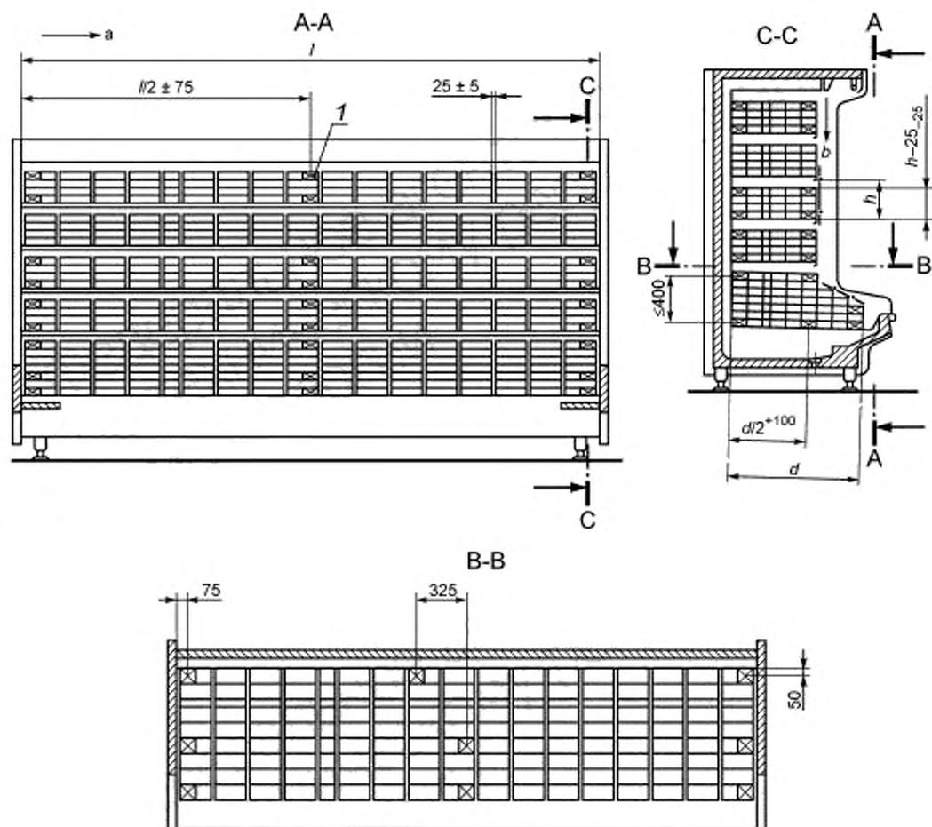
1 — термометрический контрольный пакет;  $l$  — длина шкафа;  $d$  — глубина основания полезного объема;
