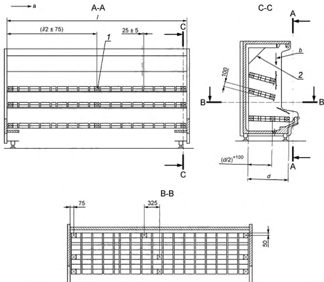
$l$  — длина шкафа;  $d$  — глубина основания полезного объема;  $1$  — термометрический контрольный пакет;
