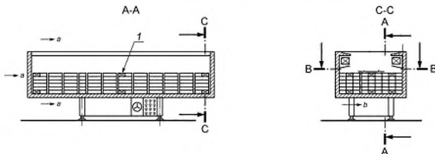
1 — термометрический контрольный пакет;  $a$  — направление воздушного потока в помещении для проведения испытаний (параллельно плоскости открытой части образца в продольном направлении);  $b$  — направление движения теплового воздушного потока, выходящего из конденсатора
