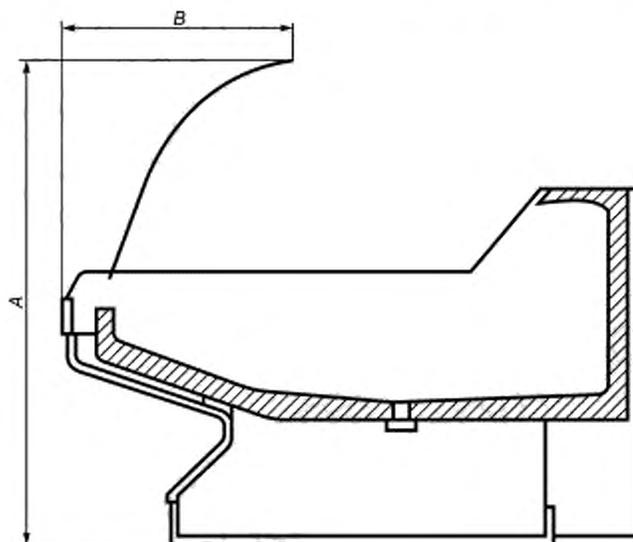
Рисунок 1 — Размеры экрана противовирусной и антимикробной защиты
