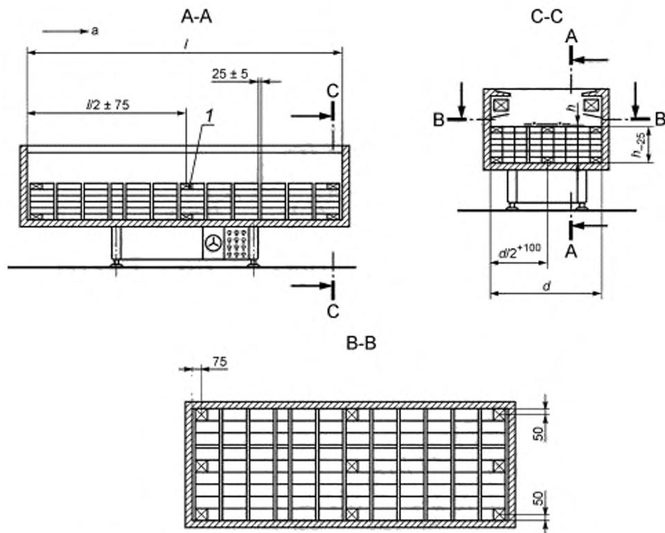
1 — термометрический контрольный пакет;  $l$  — длина витрины;  $d$  — глубина основания полезного объема;
