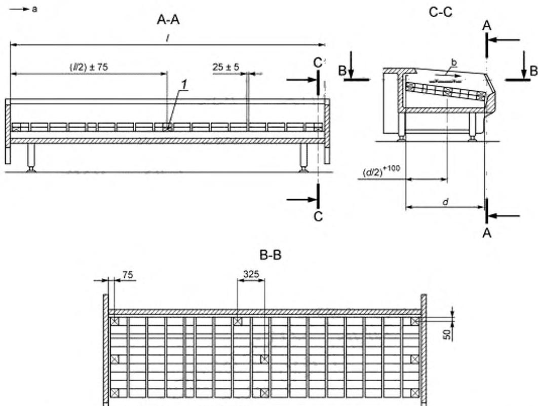
1 — термометрический контрольный пакет,  $l$  — длина витрины;  $d$  — глубина основания полезного объема;
