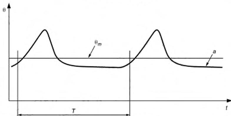
$\theta$  — температура;  $\theta_m$  — среднее значение температуры;  $t$  — текущее время;  $T$  — продолжительность периода испытаний;  $a$  — текущая величина среднеарифметического значения температуры, измеряемой с помощью всех термометрических контрольных пакетов
