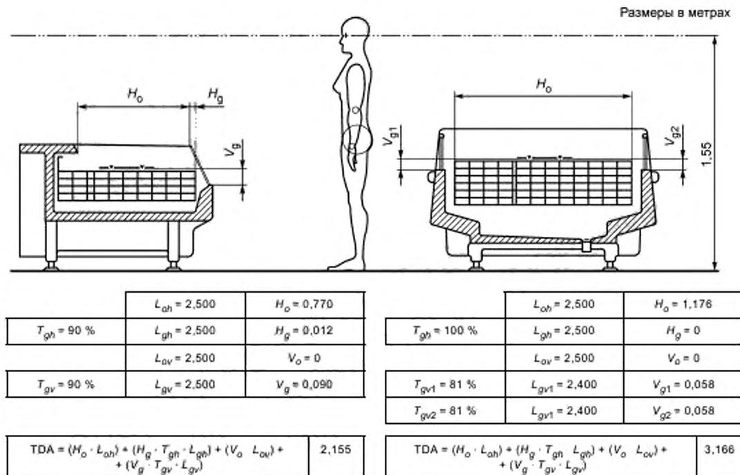
Рисунок А.2 — Горизонтальная открытая витрина островного типа
