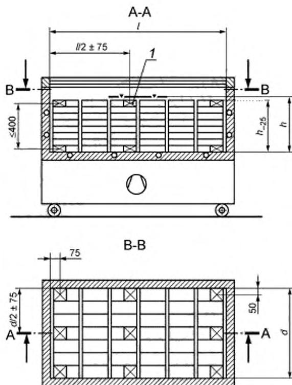
1 — термометрический контрольный пакет;  $l$  — длина витрины;  $d$  — глубина основания полезного объема;
