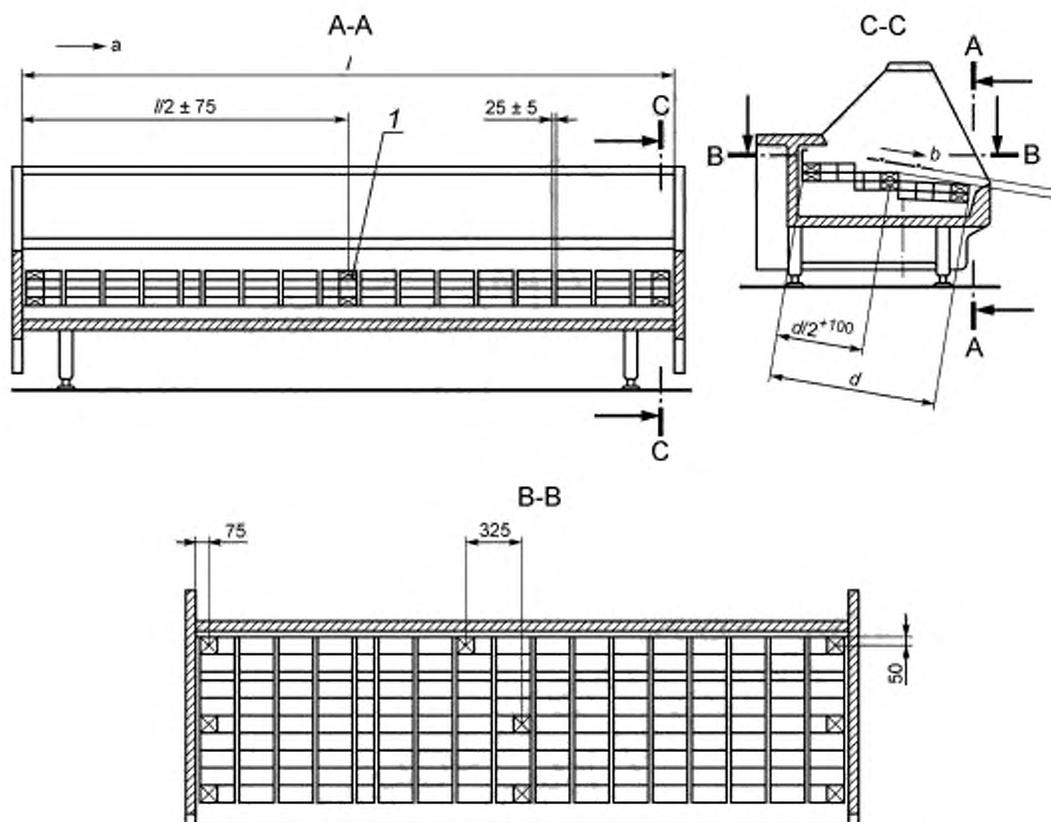
1 — термометрический контрольный пакет;  $l$  — длина витрины;  $d$  — глубина основания полезного объема;  $a$  — движение воздуха в помещении для проведения испытаний параллельно плоскости поверхности витрин (в продольном направлении);  $b$  — направление принудительного обдува в полезном объеме витрины
