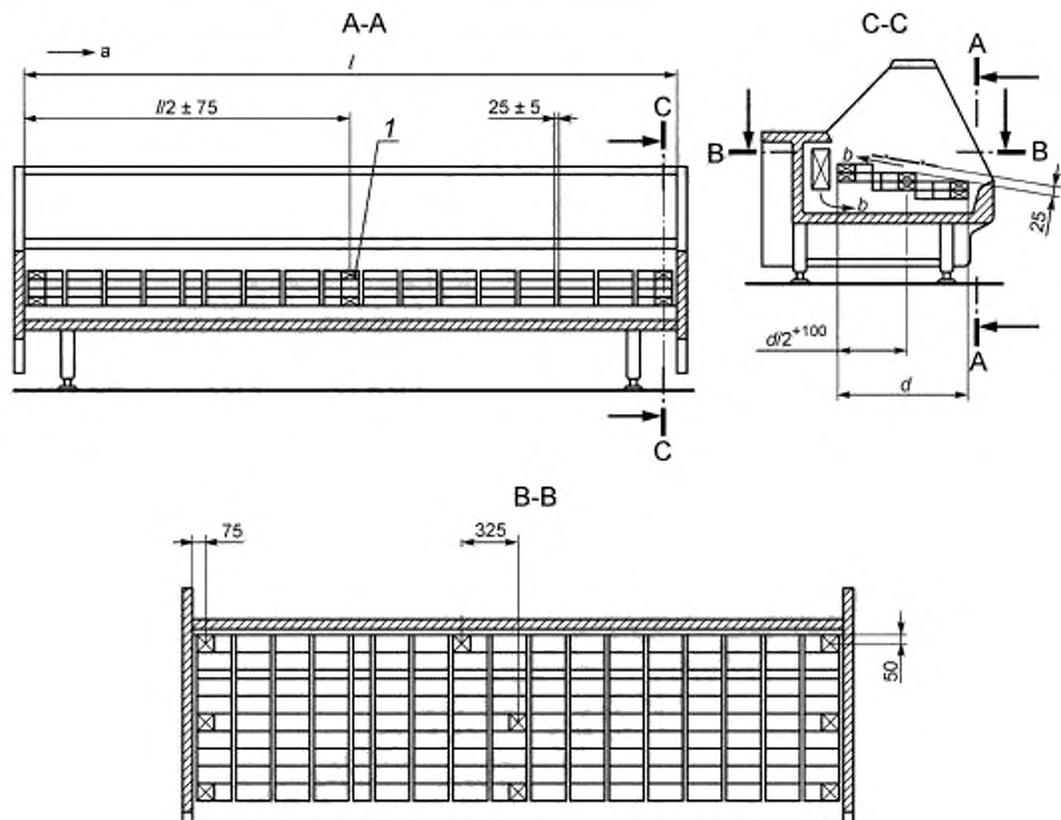
1 — термометрический контрольный пакет;  $l$  — длина витрины;  $d$  — глубина основания полезного объема;
