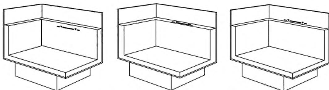
Рисунок 38 — Варианты размещения линии предельной загрузки
