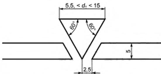
Рисунок 37 — Размеры линии предельной загрузки
