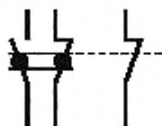
Рисунок L.1 — Пример механически связанных замыкающего и размыкающего контактов и несвязанного замыкающего контакта
