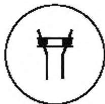
Рисунок L.2 — Символ маркировки аппарата, содержащего механически связанные контакты
