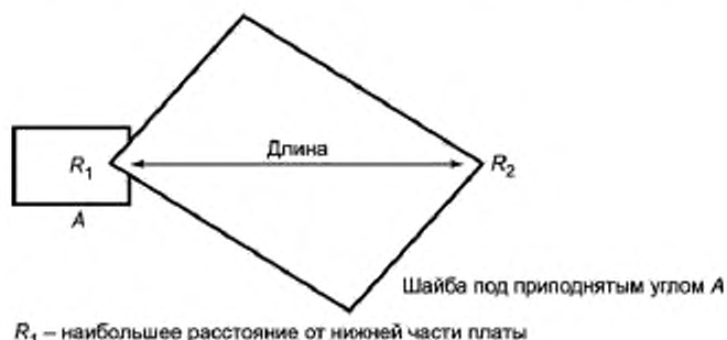
Рисунок 9 — Схема проведения измерения скручивания
