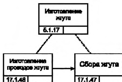
Рисунок С.4 — Процесс изготовления жгута 350-Harness
