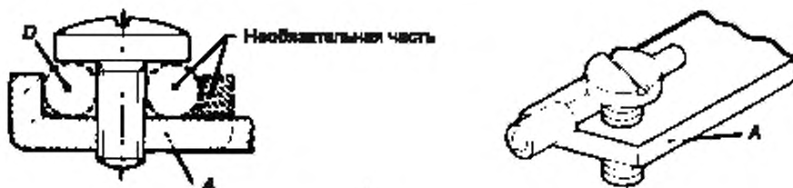
Выводы с прямым непосредственным давлением через головку винта
