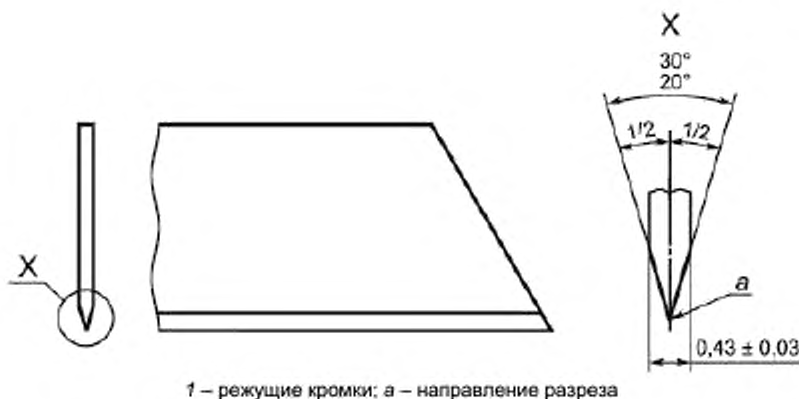
Рисунок 1 – Однолезвийный режущий инструмент
