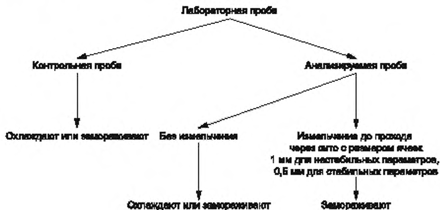
Рисунок 15 — Схема подготовки проб премиксов
