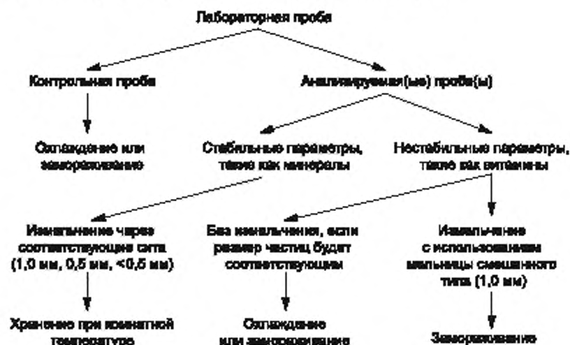
Рисунок 6 — Схема подготовки проб минеральных смесей
