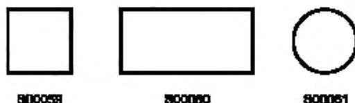
Рисунок А.1 — Стандартные символы для объекта, предусмотренные в базе данных IEC 60617
