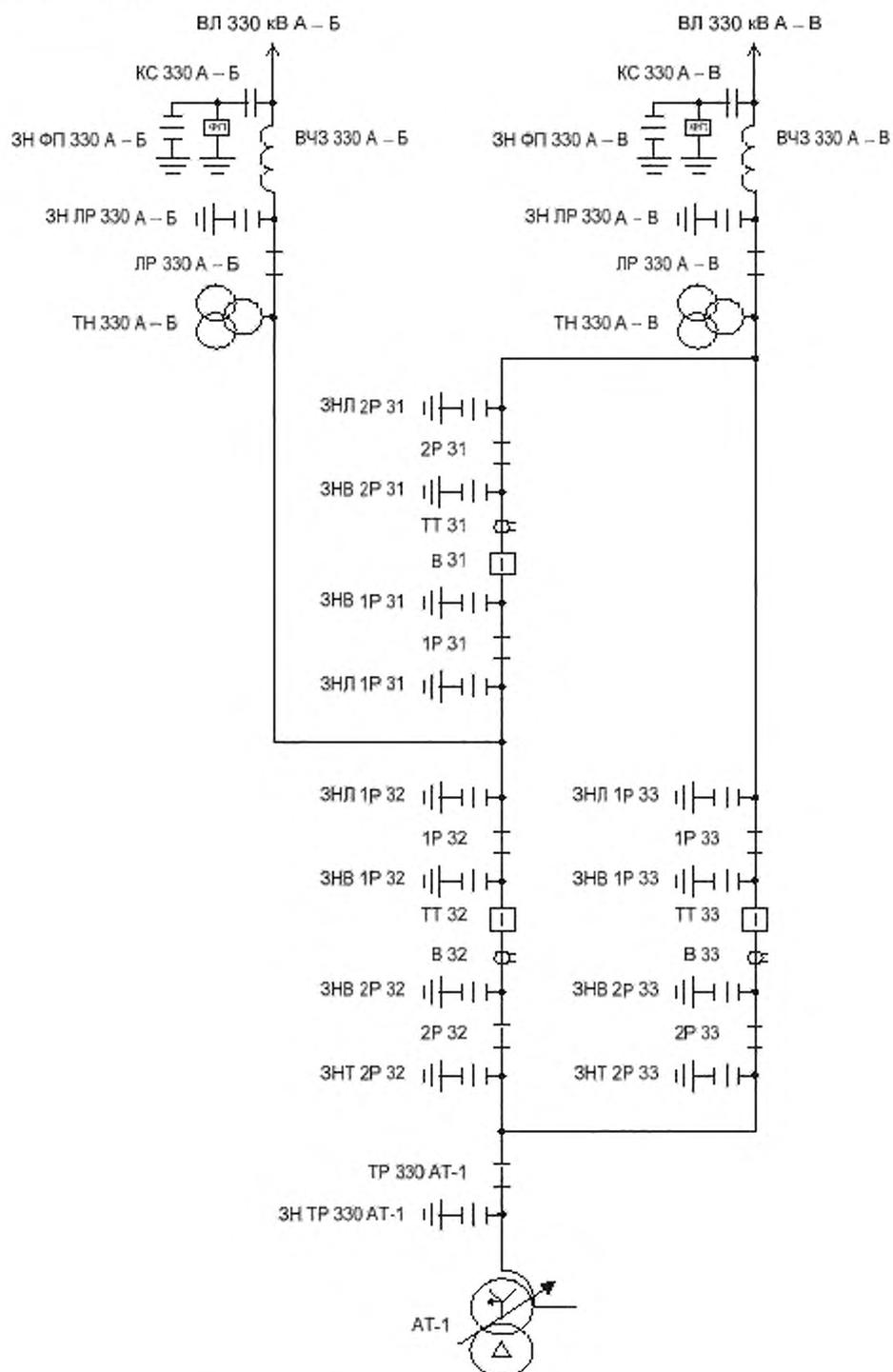
Рисунок Б.3 – Схема РУ 330 кВ типа «треугольник»
