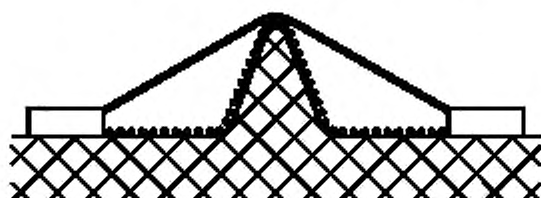
Рисунок E.3 — V-образная канавка
