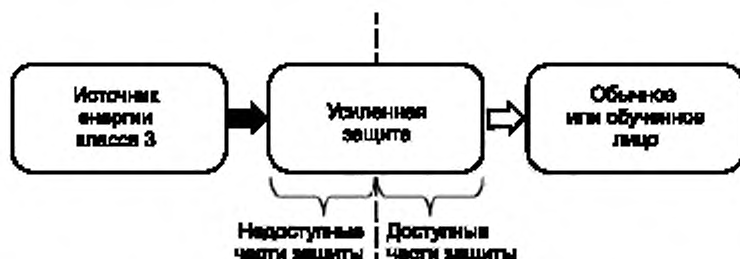
Рисунок 22 — Изображение доступных и недоступных частей усиленной защиты
