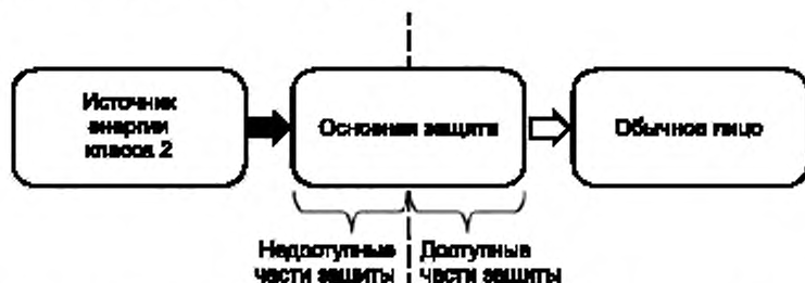
Рисунок 20 — Изображение доступных и недоступных частей основной защиты
