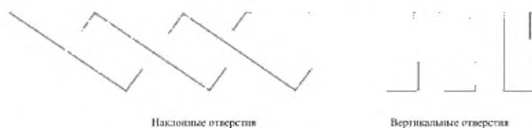
Рисунок Р.1 — Примеры поперечного сечения отверстий, конструкция которых предотвращает попадание вертикально падающих предметов внутрь оборудования
