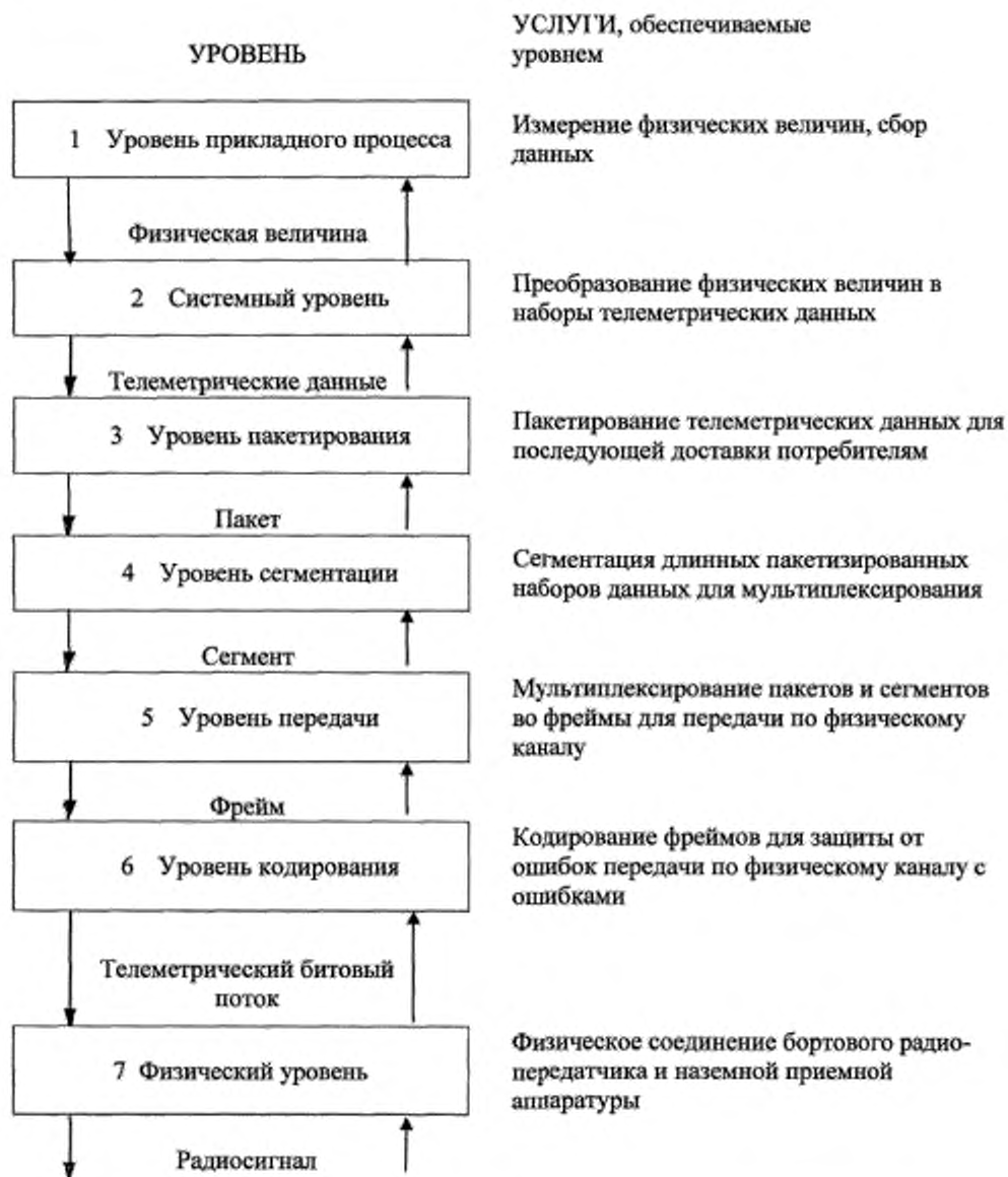
Рисунок 1 — Иерархическая модель телеметрической системы, использующей рекомендации CCSDS
