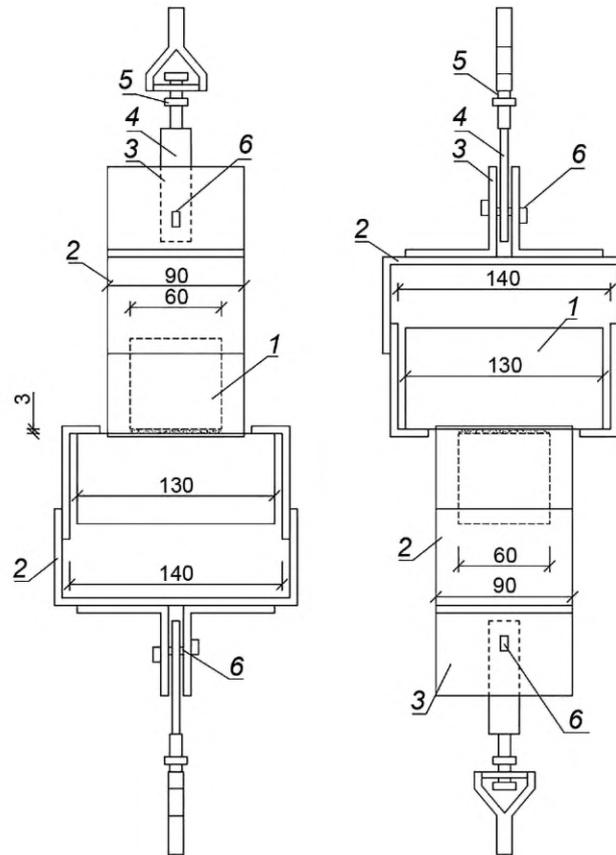
1 — испытуемый образец из камня; 2 — металлический захват; 3 — уголки 60×60×6 мм;
