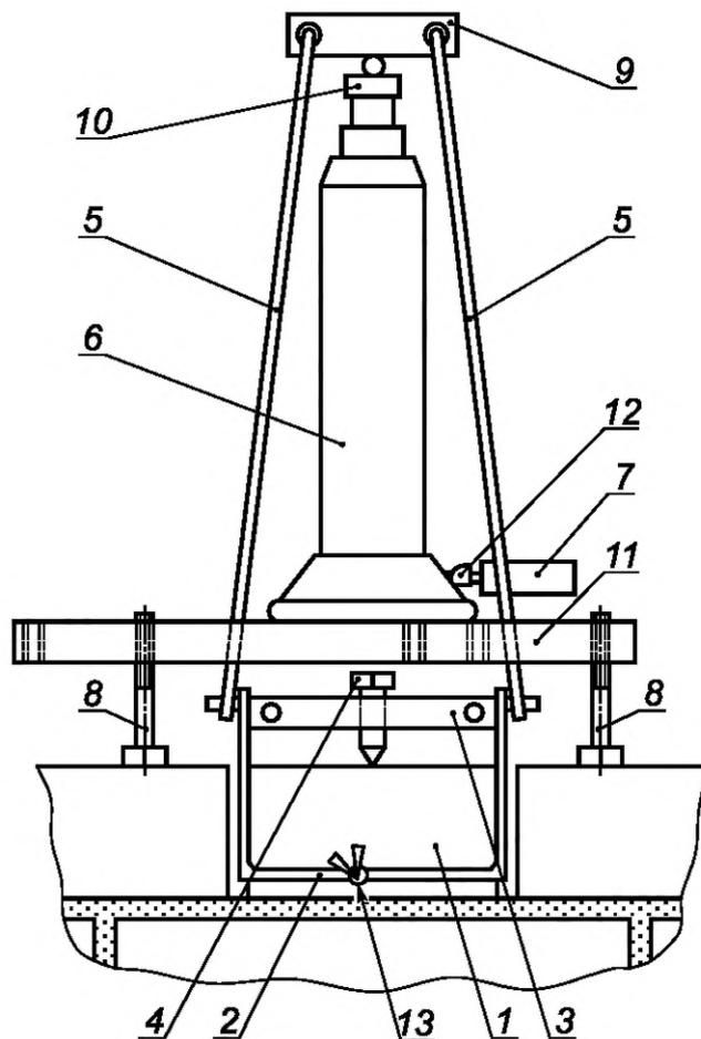
1 — испытуемый кирпич (камень); 2 — захват (тросовый); 3 — переключатель; 4 — регулировочный болт; 5 — тяга;
