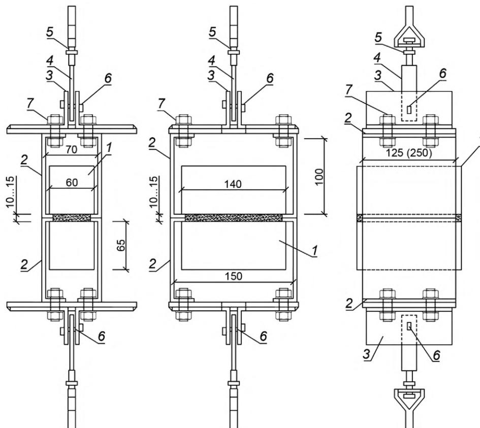
1 — испытуемый образец из кирпича; 2 — металлический захват; 3 — уголки 60×60×6 мм; 4 — металлическая пластина 20×90×6 мм; 5 — шарнир; 6 — шпилька; 7 — регулировочный болт
