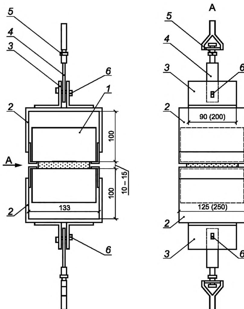
1 — испытуемый образец из кирпича; 2 — металлический захват; 3 — уголки 60×60×6 мм;
