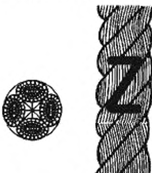
Рисунок 2 — Конфигурация 4-рядного крученого каната (тип В)
