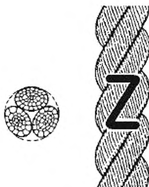
Рисунок 1 — Конфигурация 3-рядного крученого каната (тип А)
