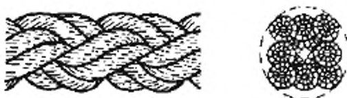
Рисунок 4 — Конфигурация 12-рядного плетеного каната (тип Т)
