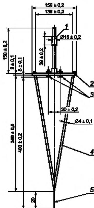
1 — регулируемый противовес; 2 — перекладина шириной  $(12 \pm 0.1)$  мм; 3 — шар диаметром 8 мм; 4 — рама; 5 — стрелка
